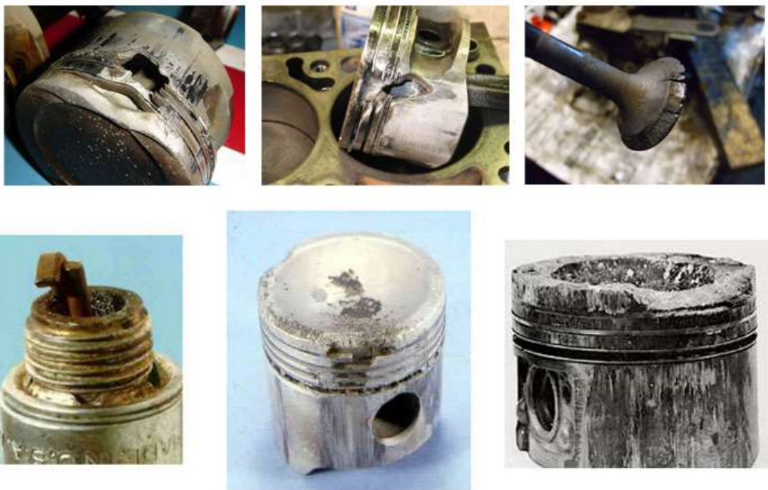
Рисунок 3.3 – Пошкодженні деталі внаслідок детонації
