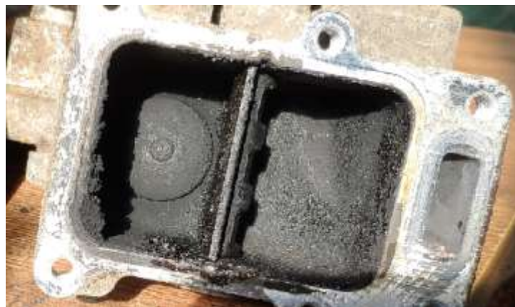
Рис.2. Відкладення на тарілці клапана EGR
