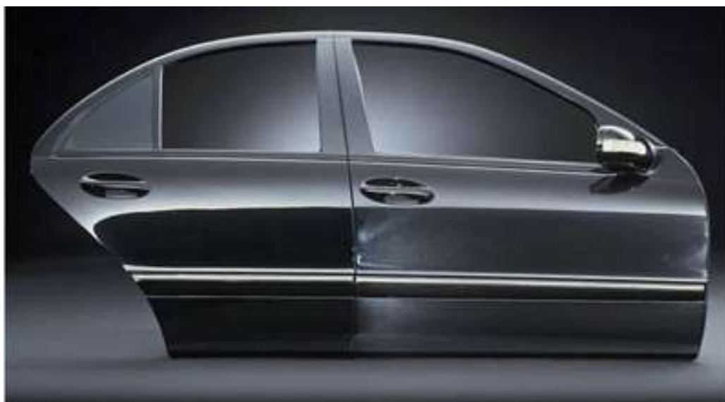
Рисунок 2 – Зовнішній вигляд нанопокриття (ліворуч) та традиційного лакофарбового покриття (праворуч) після 5 років випробування
