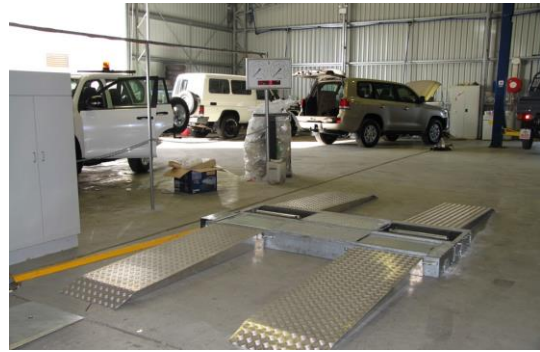
Рис. 7 – Мобільний гальмівний роликовий стенд VM3010 (Данія)
