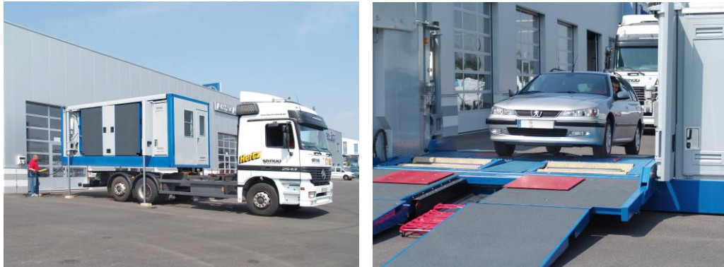
Рис. 5 – Універсальна мобільна станція технічного контролю всіх типів автотранспорту MTL-15 фірми МАНА
