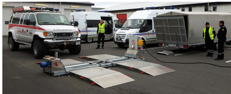
Рис. 4 – Мобільна станція VM Mobile Trailer solution (Данія)
