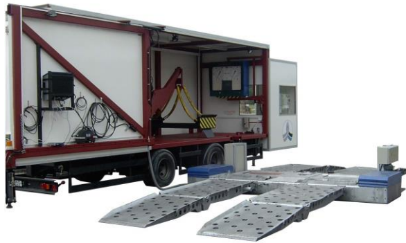
Рис. 3 – Комплексна придорожня станція техогляду Energotest MVA-40 (Венгрія)
