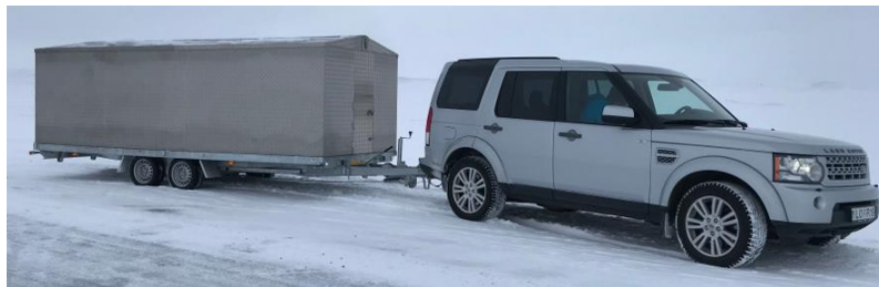
Рис. 3 – Комплексна придорожня станція техогляду Energotest MVA-40 (Венгрія)
