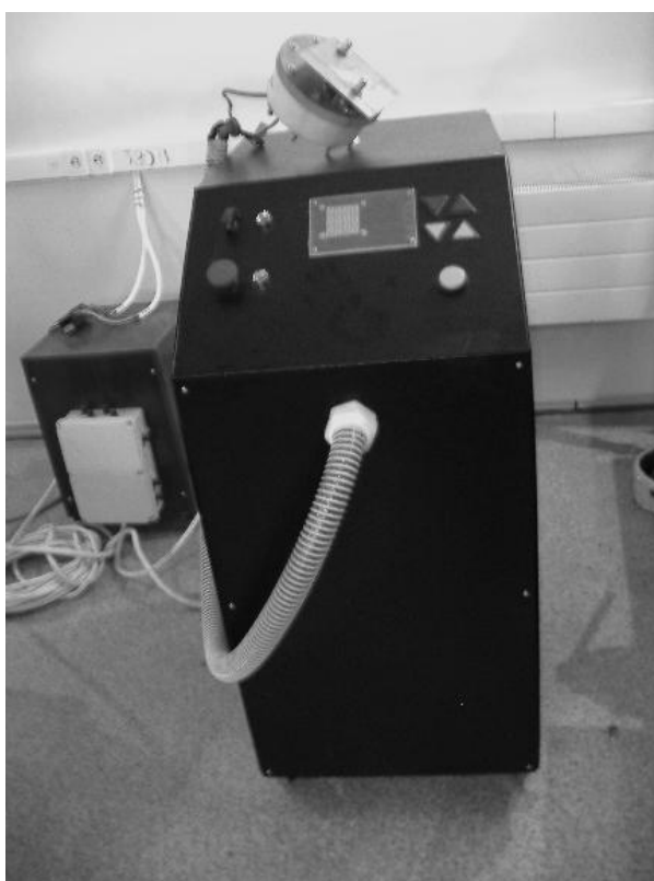
Рис. 4.21. Магнитно-импульсная установка МИУС-2 с максимумом запасаемой энергии ~ 2,4 кДж при напряжении ~ 2 кВ
