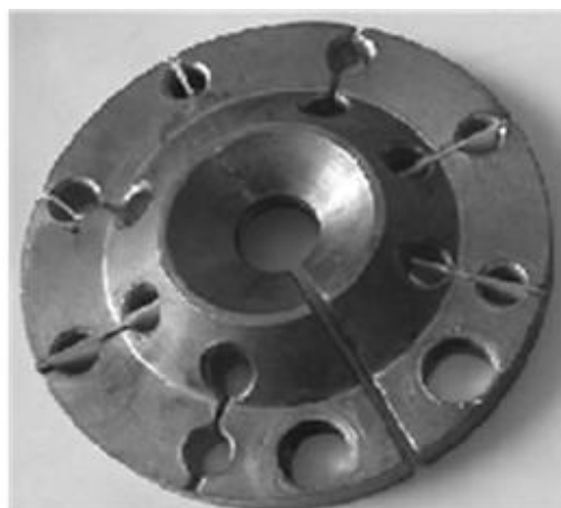
Рис. 1.1. Согласующее устройство различного конструктивного исполнения: а) принципиальная схема «согласующего цилиндрического устройства», б) принципиальная схема «согласующего дискового устройства», 1 – первичная обмотка, 2 – одновитковый индуктор, 3 – листовая заготовка; в) фотографии с цилиндрическими и дисковыми конструкциями; г) одновитковый индуктор с коническим внутренним отверстием
