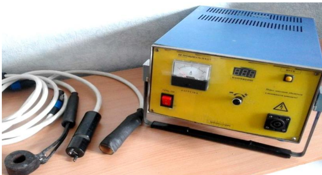
Рис. 4.2. Внешний вид «источника №2», Электрические параметры: Питание: сеть 220 В – 50 Гц; Максимальная выходная мощность: 4 кВт; Диапазон регулировки мощности: 0...4 кВт; Рабочая частота: 20 кГц.
