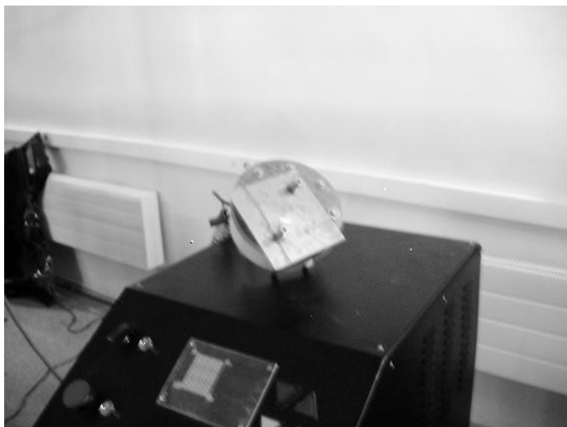
Рис. 4.23. Общий вид: источник мощности МИУС–2 с инструментом притяжения и листовым образцом с вмятиной, подлежащей устранению
