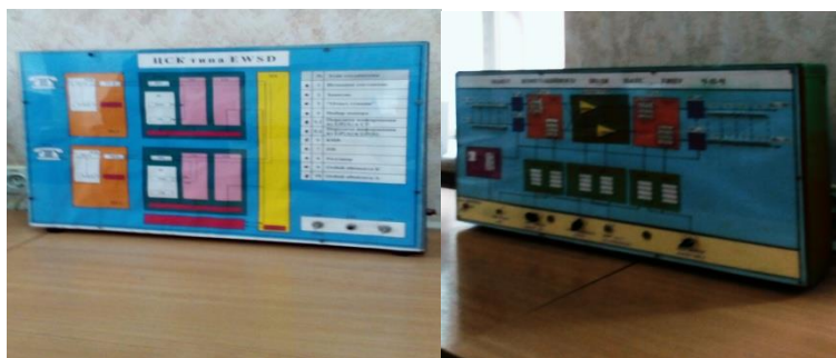
Рис.2 Коммутационная станция EWS D и макет коммутационного поля ЦАТС.
