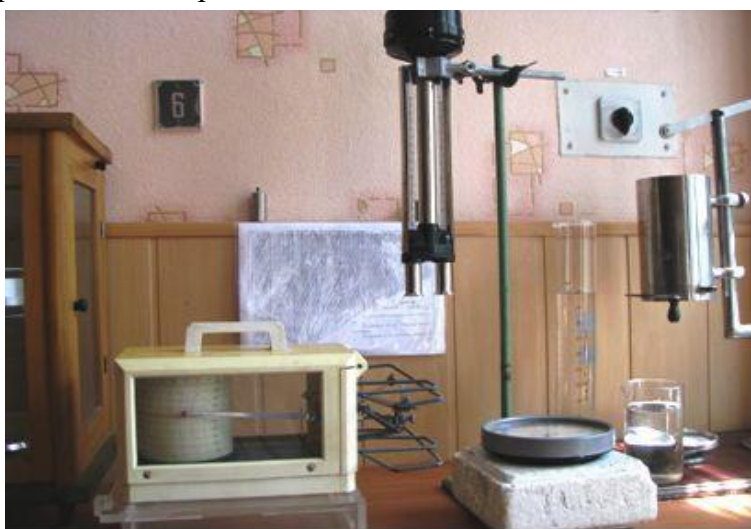
Рис. 1. Обладнання лабораторної роботи по визначенню вологості повітря.
