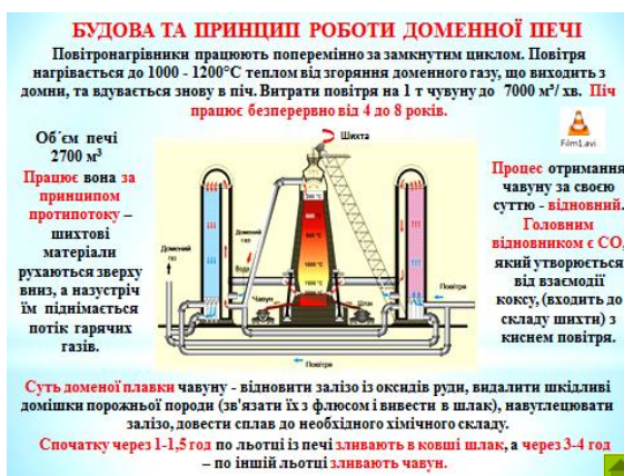
Рис. 2. Будова та робота доменної печі
