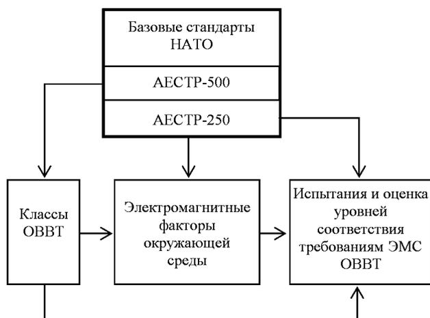
Рис. 1. Обобщенная структурная схема обеспечения требований ЭМС ОВВТ, регламентированных стандартами НАТО
