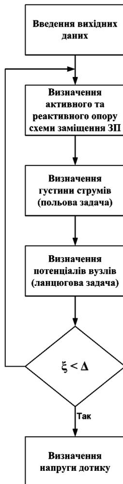
Рис. 3. Алгоритм визначення напруги дотику розрахунковим методом
