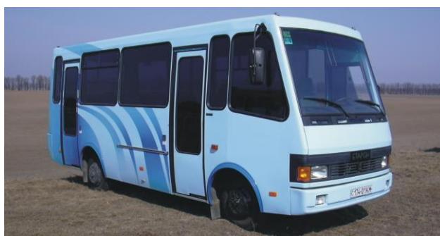
Рис 2. Специальный микроавтобус «Сула», г. Лубны с отштампованными на прессе ПЭГ-ХАИ-500 передней и задней частью крыши, арками колёс и угловыми участками будара ( а ), автобус марки «Эталон» г. Борисполь с угловыми передними и задними участками крыши ( б )
