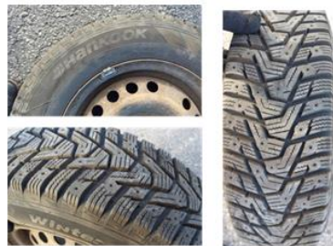
Рисунок протектора зимових шин фірми Hankook моделі Winter I pike типорозміру 175/70 R13
