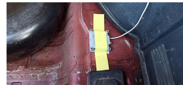
Розташування та кріплення трикоординатного датчика лінійних прискорень у багажнику легкового автомобіля Daewo Sens
