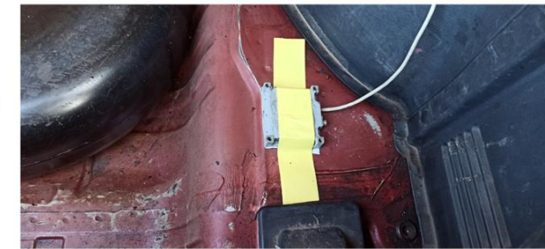
Розташування та кріплення трикоординатного датчика лінійних прискорень у багажнику легкового автомобіля Daewoo Sens
