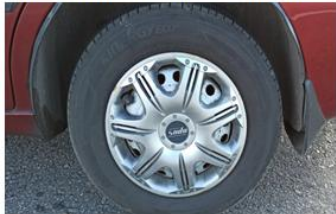
Колесо з літньою шиною фірми Hankook моделі Kinergy Eco 2 типорозміру 175/70 R13
