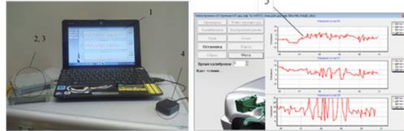
1 – Персональний комп'ютер для реєстрації вимірювальної інформації; 2, 3 – трикоординатні датчики для вимірювання прискорень автомобіля; 4 – GPS приймач; 5 – програма для реєстрації і візуалізації експериментальних даних
