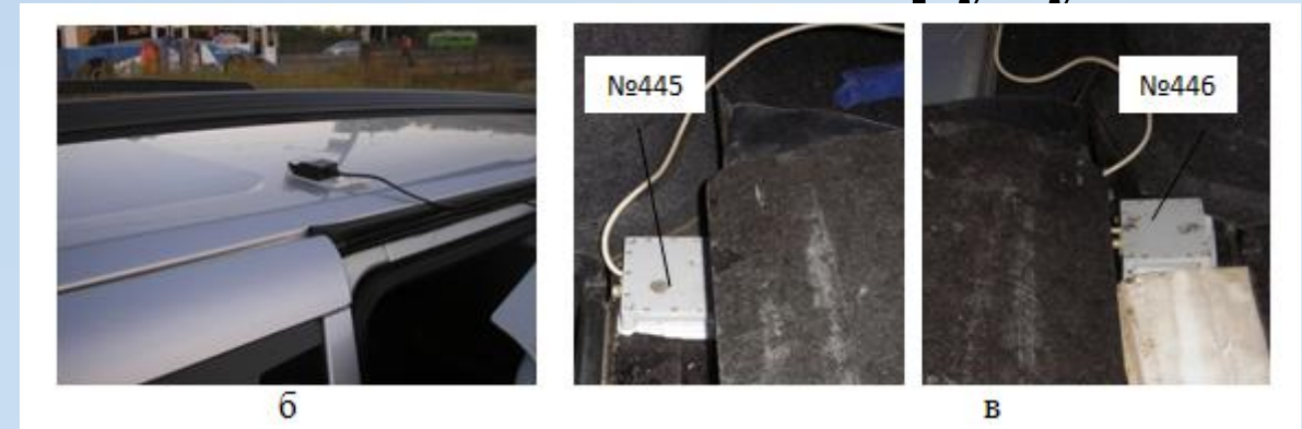
Рисунок 2 – Схема встановлення GPS/GLONASS приймача і трикоординатних датчиків прискорення на кузові автомобіля ВАЗ-2111 при проведенні експериментальних досліджень
