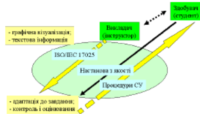
Рис. 2. Принципова схема віртуального тренажера випробувальної лабораторії (в розрізі рівнів ієрархії)
