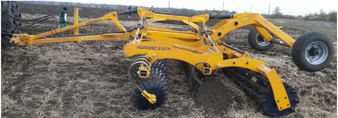
Рисунок 1 – Загальний вигляд агрегату ґрунтообробного сімейства СДА, модель СДА-5 (AGRIDISC 5.0 TF) в робочому положенні
