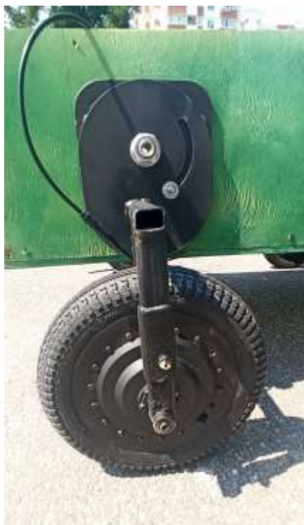
Рис. 3 – Мотор-колесо безкіпажного колісного візка з електроприводом
