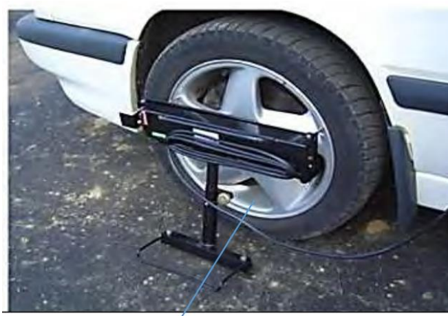
Рисунок 1 – Прилад для перевірки сумарного люфту в кермовому управлінні автомобіля – датчик руху колеса
