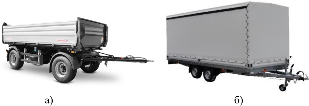
а) з рознесеними осями; б) з центральними осями
