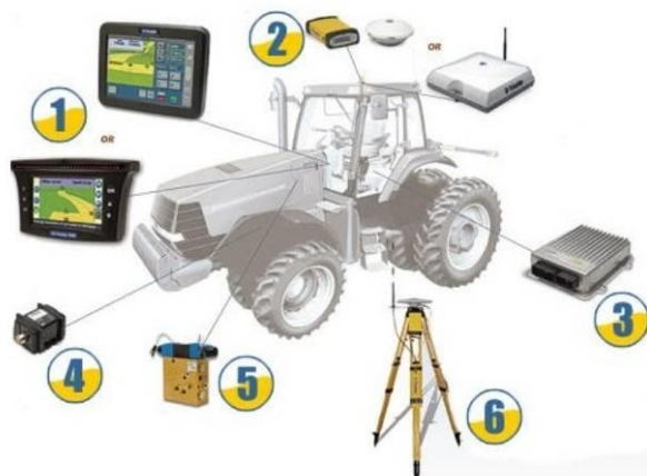
Рис. 1 Система автоматичного управління трактором
