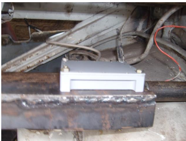
Рисунок 1.3 – Установка датчиків прискорень у багажнику випробовуваного автомобіля
