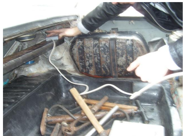
Рисунок 1.3 – Установка датчиків прискорень у багажнику випробовуваного автомобіля
