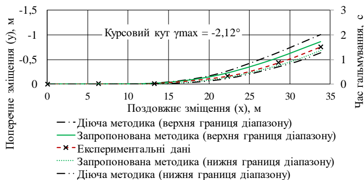
Рисунок 20 – Траєкторія руху центра мас загальмованого автомобіля Skoda Octavia при нерівномірній дії гальмівних моментів
