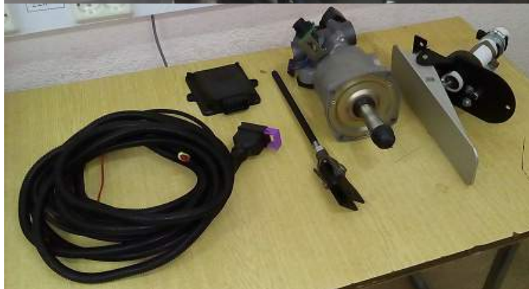
Рисунок 6.25 — Складові системи керування зчепленням та їх установка на автобусі А10С3А виробництва Запорізький автомобілебудівний завод
