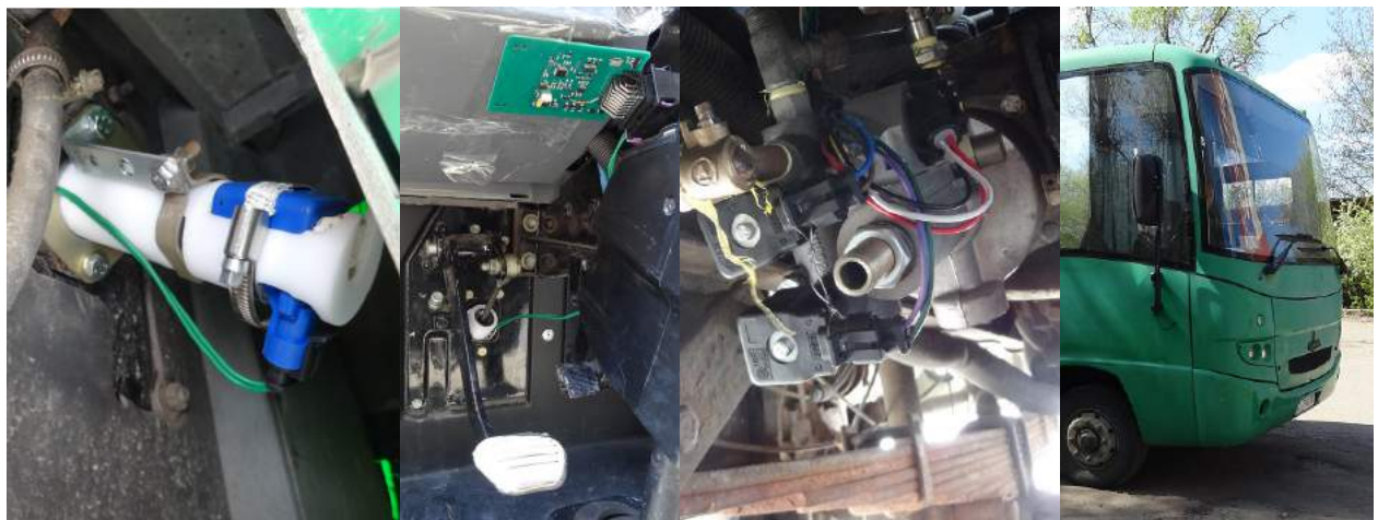
Рисунок 6.23 — Випробування системи керування зчепленням на автобусі МАЗ-256.200
